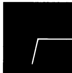
Diode in Reihe mit 51 \Omega
